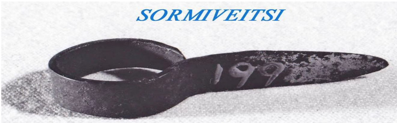
199 SORMIVEITSI Lautala Verkonparsijan työkalu, joka laitettiin nimettömään sormeen. Verkkoa parsittaessa veitsellä katkaistiin ylimääräiset langat.
