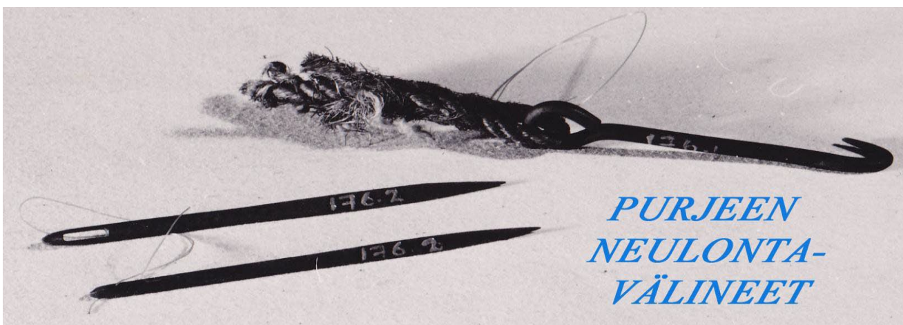
176 PURJEENNEULONTAKOUKKU JA 2 NEULAA Lautala Kun purjeen saamaa ommellaan, kiinnitetään jo ommeltu osa koukulla seinään tai penkin jalkaan. Tammiassa purjeet leikkasi Niilo Kala (s. 1853).
