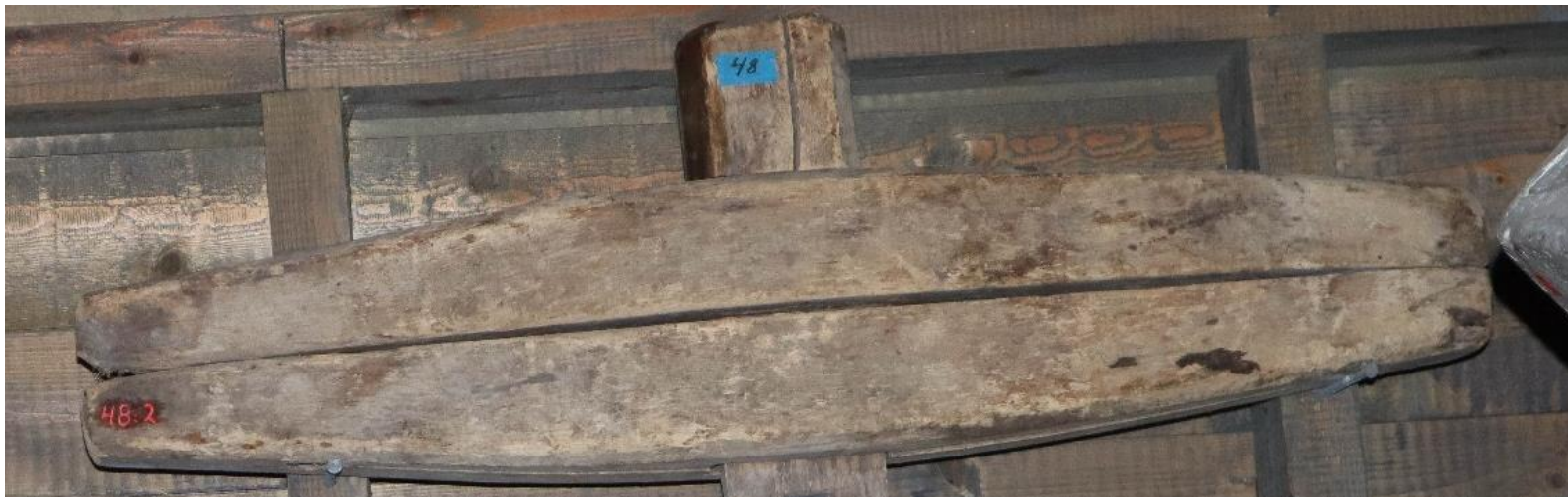
Salvattimet, puristimet, joita käytettiin laivan laitalankkujen kaariin kiinnittämiseen laivaa rakennettaessa.
